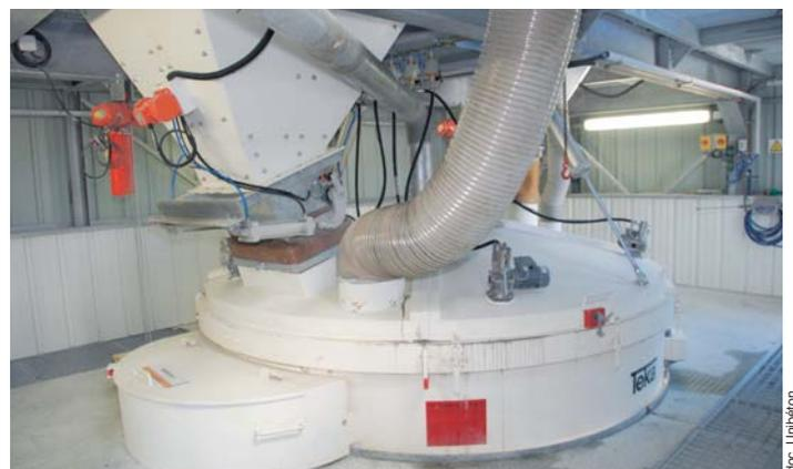
▲ Pour faciliter son entretien, le malaxeur de la centrale Unibéton de Guerville dispose d'un nettoyeur automatique haute pression.
